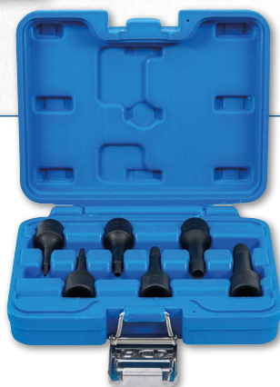
Spiral-Profil-Steckschlüssel-Satz / Schraubenausdreher | Antrieb Innenvierkant 10 mm (3/8") | 2 - 10 mm | 6-tlg.
